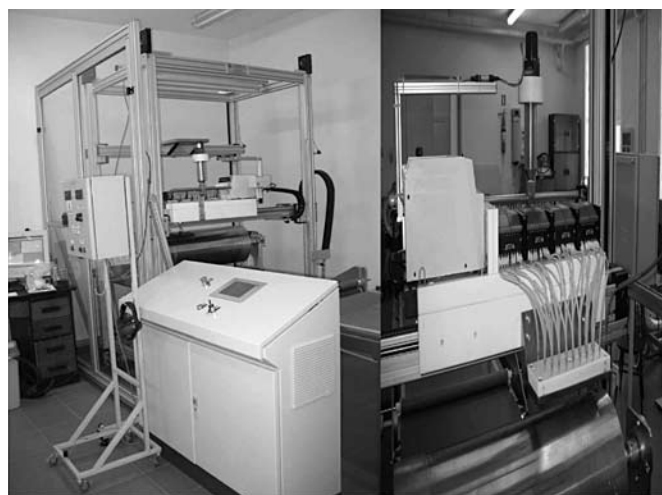
Rys. 5. Widok wielokapilarowego stanowiska do wytwarzania włókien metodą elektroprzędzenia
