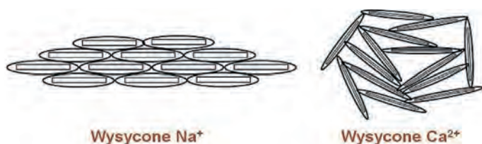
Rys. 5. Orientacja cząstek gruntu po wysyceniu jonami sodu oraz wapnia [20]
