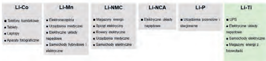
Rys. 5. Zastosowanie ogniw litowo-jonowych w zależności od zastosowanych materiałów elektrodowych [8]
