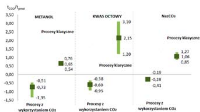
Rys. 4. Porównanie śladu węglowego produktów: metanolu, kwasu octowego i Na 2 CO 3 otrzymywanych metodami klasycznymi oraz z zastosowaniem CO 2 [23]
