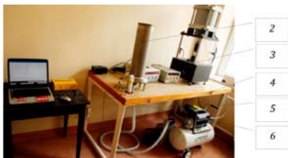
Rys. 2. Stanowisko pomiarowe: 1 – tabletkarka; 2 – komora do pomiaru energii; 3 – układ pobudzenia i zapłonu; 4 – przewód pompy próżniowej; 5 – sprężarka powietrza; 6 – system rejestracji danych
