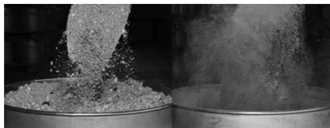
Rys. 1. Zdjęcia przedstawiające pyły aluminiowe, z lewej aluminium DEPUVAL; z prawej pył płatkowany [8]
