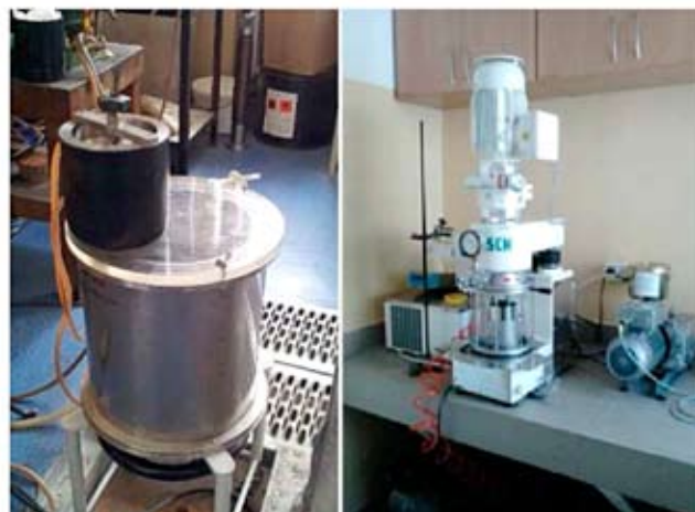
Rys. 1. Stanowisko do odlewania paliwa pod obniżonym ciśnieniem (z lewej) oraz mieszalnik NETZSCH (z prawej) (aparatura IPO w Warszawie)
