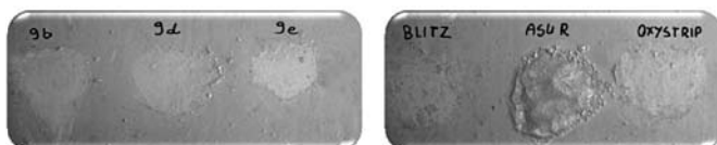
Rys. 5. Efekt działania preparatów serii GK na stare (10–15-letnie) powłoki lakiernicze nałożone na sklejkę (wiele warstw emalii olejno-ftalowych), w porównaniu do preparatów dostępnych w handlu
