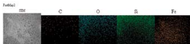
Rys. 7. Wyniki badań EDS i mapowania dla krzemionki ze zdyspergowanymi na powierzchni tlenkami żelaza i miedzi
